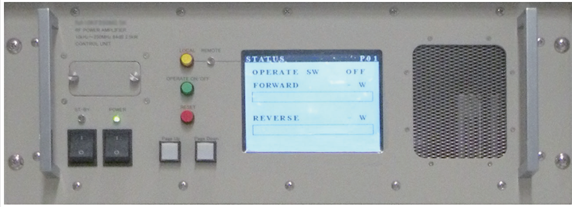
〔写真〕 Multi Monitoring Systemのフロントパネル表示ディスプレイの参考例
